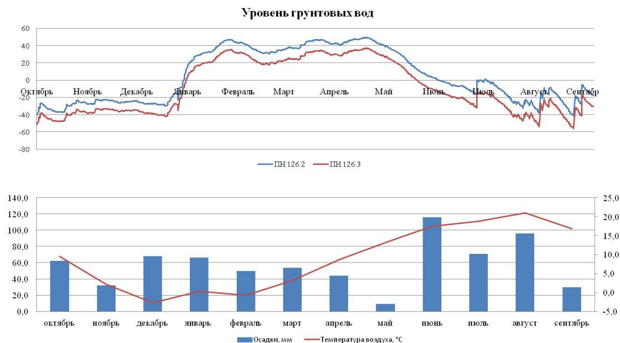
Рисунок 13.20 – Ход кривой уровней грунтовых вод, осадков и температуры воздуха в течение гидрологического года
